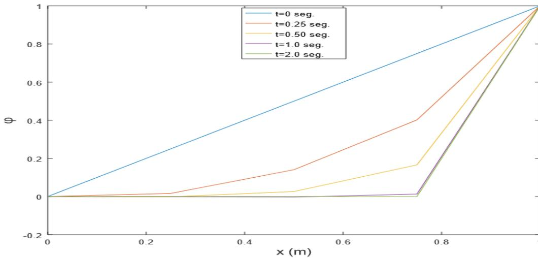
**Figura 1:** Distribución espacial y temporal del contaminante para una corriente uniforme ( $u = 1$ ,  $k = 0.01$ ,  $\theta = 0.5$ ; Crank-Nicolson).
