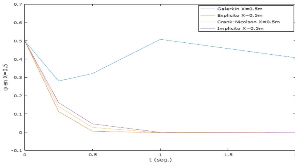
**Figura 2:** Evolución temporal de la concentración del contaminante en el punto medio del canal por diversos métodos. Se observan las oscilaciones numéricas introducidas por el método de Galerkin (decaimiento no monótono de la concentración).
